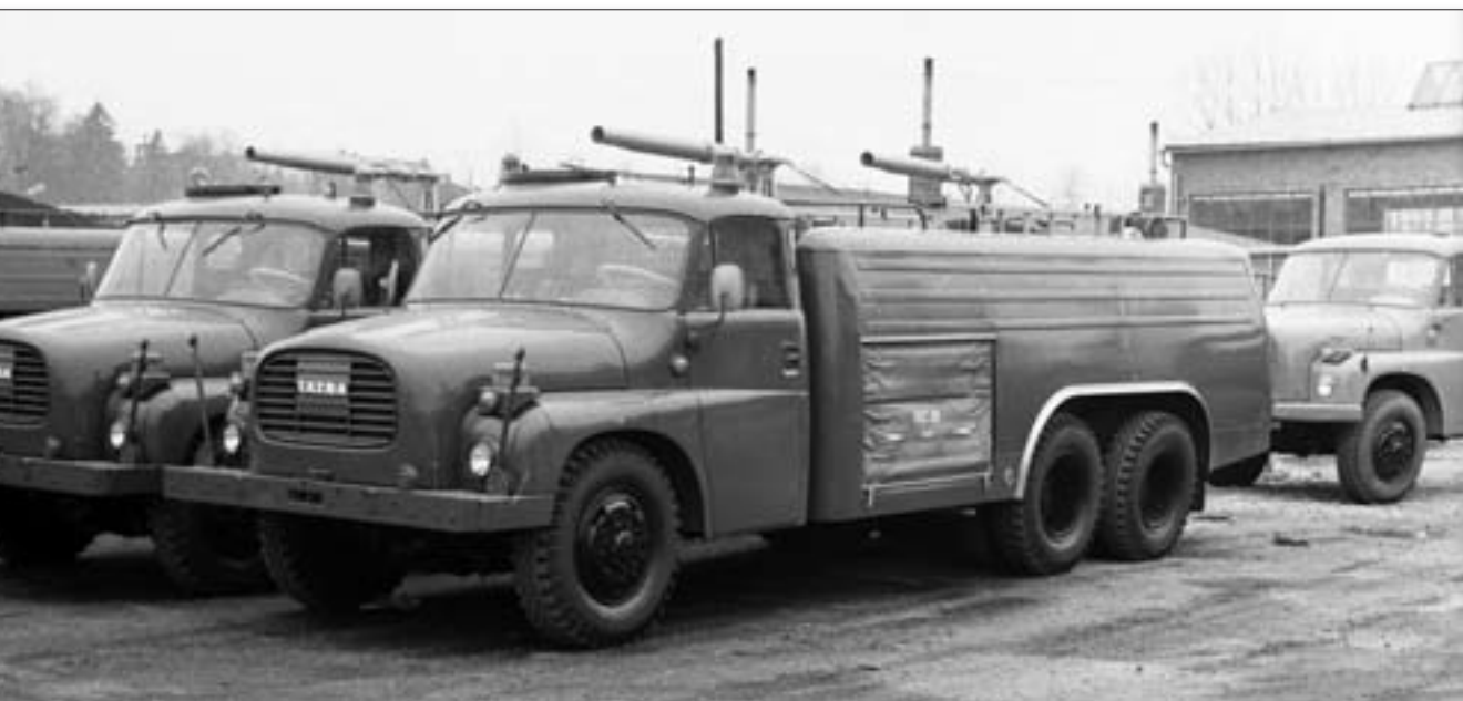
CAS 32 na podvozku Tatra 148 byla schopná nasazení v těžším terénu.
